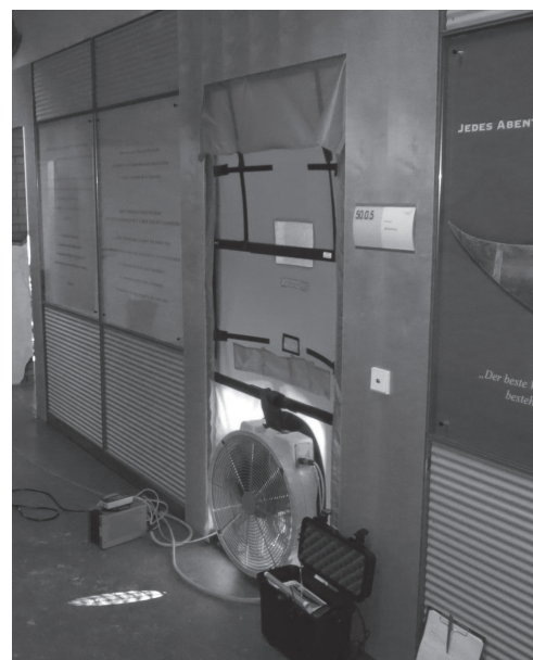
Bild 4. Radon-Dichtheitsprüfung unter Einbeziehung des Unterdruckverfahrens (Rn 50 -Test) bei 50 Pascal Unterdruck.
